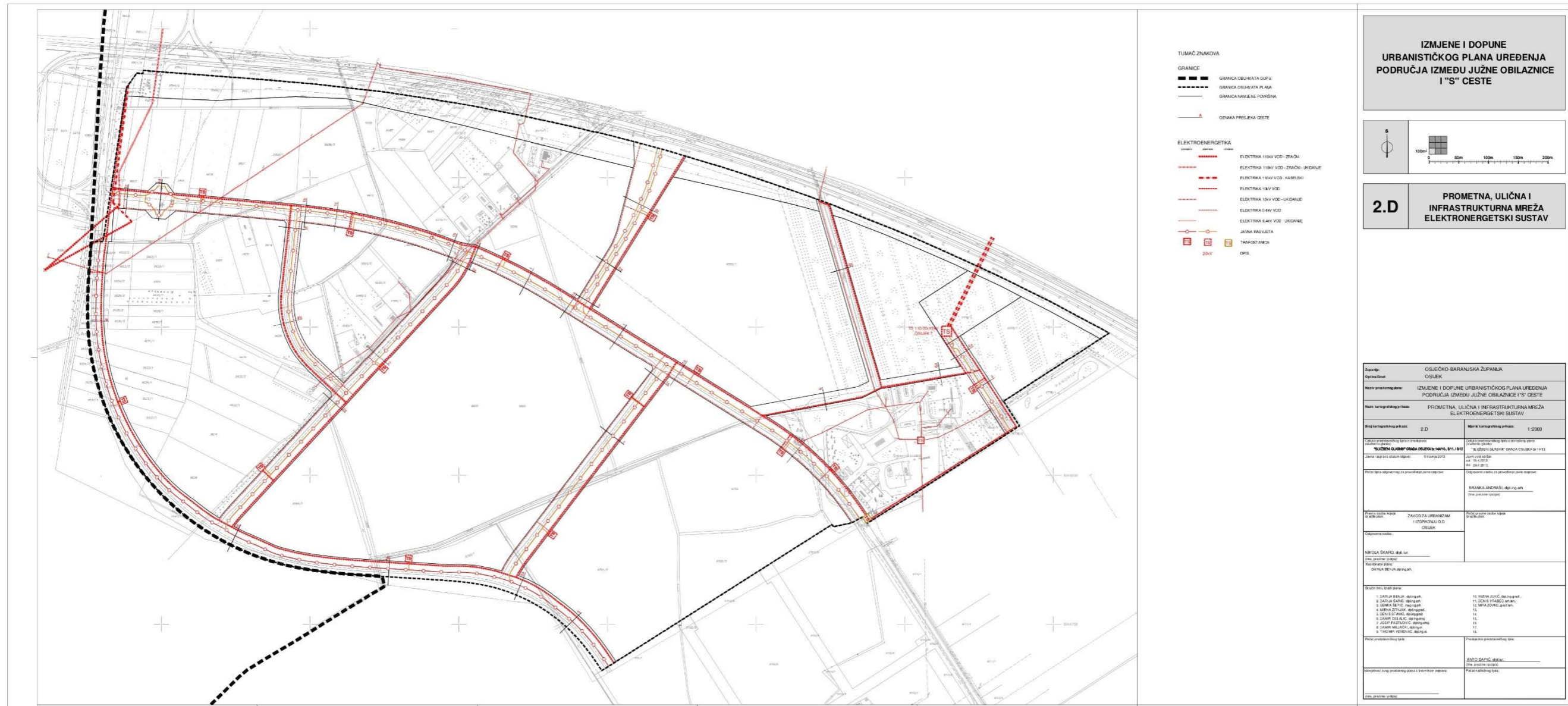
Slika 8. Prometna, ulična i infrastrukturna mreža – Elektroenergetski sustav (Izmjene i dopune Urbanističkog plana uređenja područja između Južne obilaznice i S ceste)
